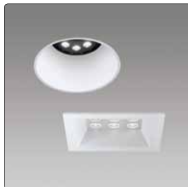
CITY vgradno stropno LED svetilo z usmerjeno svetlobo, 17W/23.8W, svetlobni kot 30°, 1028/1440lm ASTRO vgradno stropno LED svetilo z usmerjeno svetlobo, 9 x 1W, svetlobni kot 30°, 720 lm
