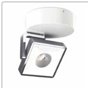
STUDIO MONO UP kolekcija stropnih in stenskih svetil z LED virom in širokokotno lečo, 770lm, 2700K, CRI83
