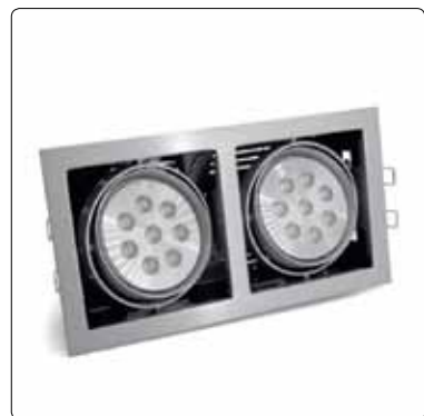
LIRA vgradno stropno LED svetilo z dvema gibljivima viroma, 44.2W, 2434lm, s koti 8° / 25°/40° / 60°, CRI80
